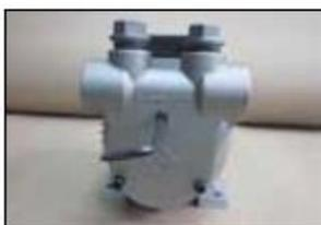
винты равномерно и в диагональной последовательности. Сначала закрутите винты вручную, затем затяните их с помощью подходящего инструмента на 1 ПОЛНЫЙ оборот.
